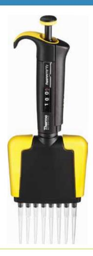
Enthält: Finnpipette F2 Mehrkanalpipette, Kalibrierwerkzeug, Modul-Entnahmewerkzeug, leere ID-Etiketten für die persönliche Benutzerkennung, Regalhaken, Bedienungsanleitung und Kalibrierzertifikat
